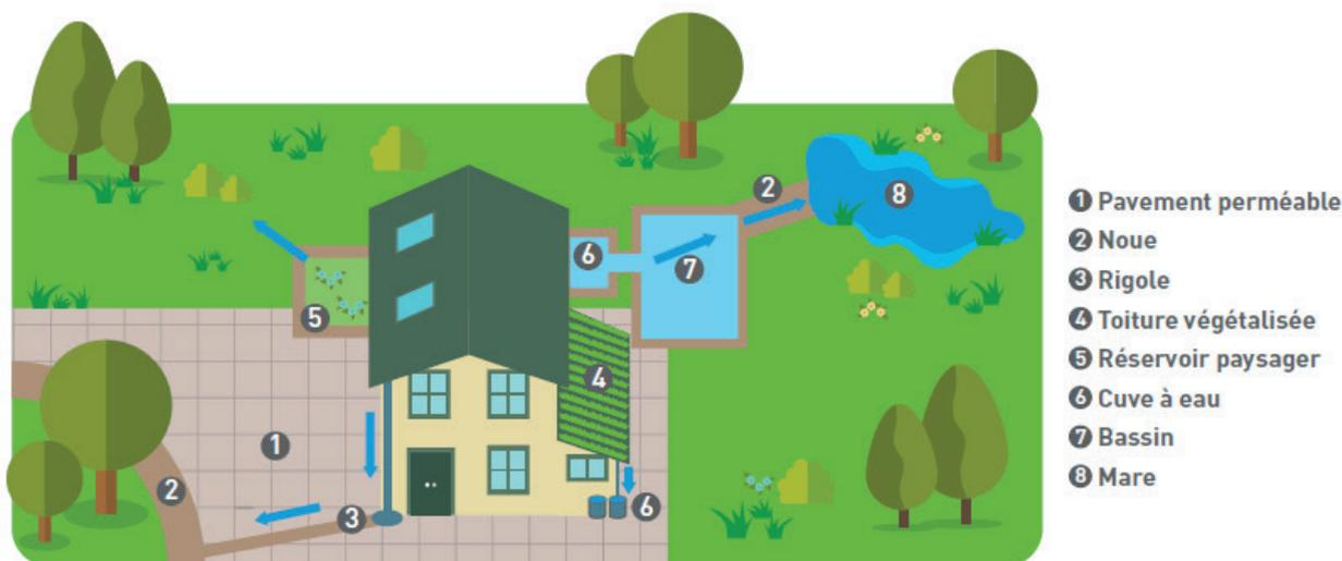
Figure 16: Exemple de différentes techniques alternatives pour gérer les eaux pluviales d'une maison – Source : Symasol, Gestion des eaux pluviales – Guide pour la mise en œuvre de techniques alternatives, juin 2016
