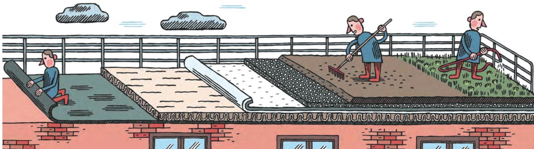
Schéma des étapes pour végétaliser une toiture-terrace - © CSFE
