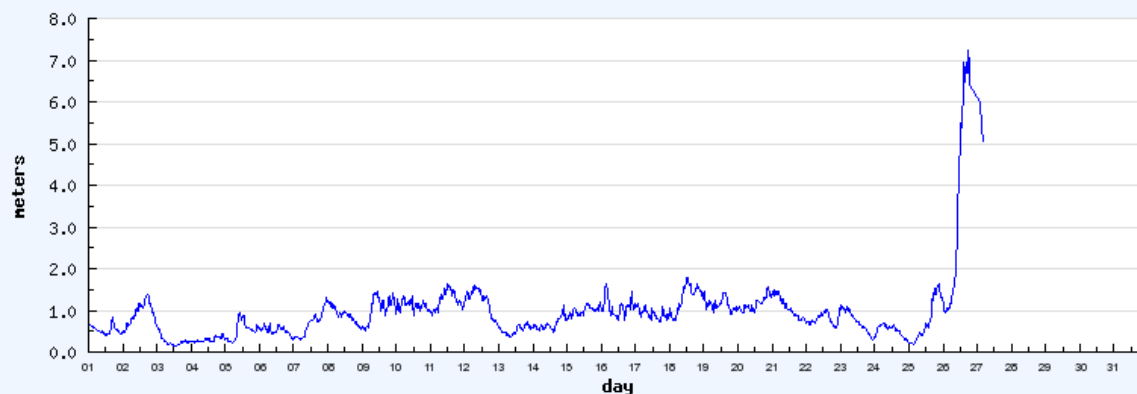
Evolution de la Hauteur significative spectrales des vagues (HM0) pour la campagne 06601 au mois de Decembre 2008
