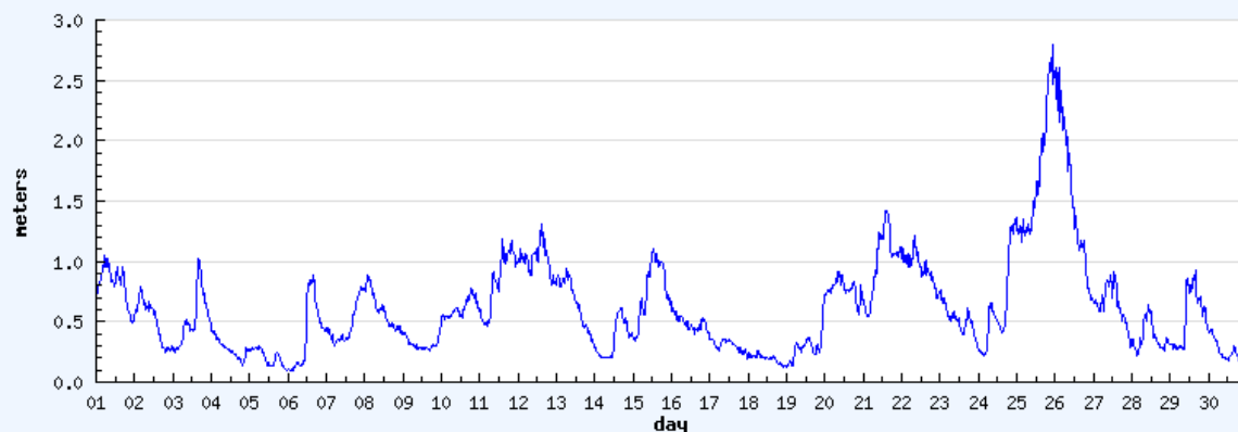
Evolution de la Hauteur significative spectrales des vagues (HM0) pour la campagne 06601 au mois de Avril 2009
