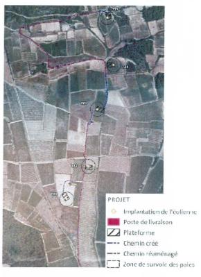
dédiées au montage. L'accès aux éoliennes est assuré par des chemins ruraux existants à renforcer sur 1476 mètres linéaires et, par de nouvelles pistes à créer sur 660 mètres linéaires. L'itinéraire permettant de desservir les éoliennes est prévu depuis l'autoroute A61, via la RD6113, puis les voies départementales locales. La durée du chantier est estimée de 6 mois à 1 an, en fonction des conditions météorologiques.
