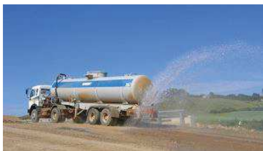
Exemple de camion citerne d'arrosage utilisé sur des chantiers pour l'arrosage des pistes circulées (chantier A9 – Anne Scher)
