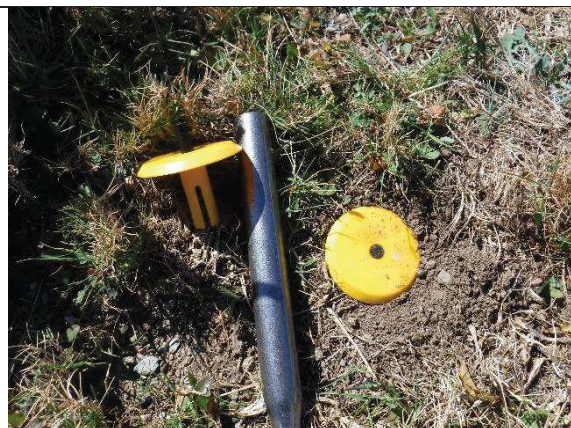
Matériel utilisé pour le marquage des lignes de suivi
