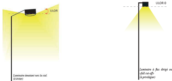
Lampadaire émettant vers le ciel à éviter (à gauche) et lampadaire émettant vers le sol à privilégier (à droite)
