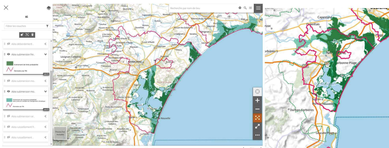
Cartographie du TRI - Territoire à risque important d'inondation + secteurs soumis à aléa débordement et submersion fréquent ou décennal de forte et moyenne probabilité, avec prise en compte du changement climatique (portail georisque)
