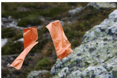
Rubans adhésifs posés par le GP, se déchirant et brûlés par le soleil.
