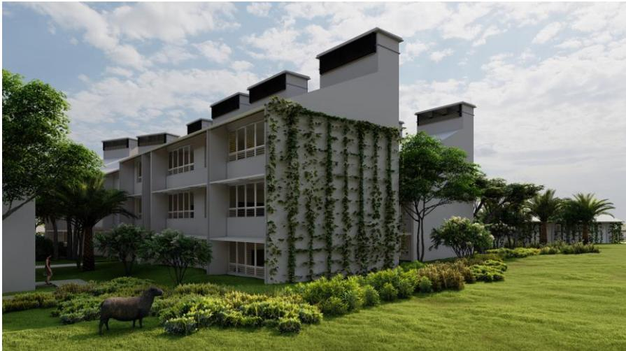
Les salles de classes possèdent des cheminées thermiques pour permettre une ventilation naturelle.
