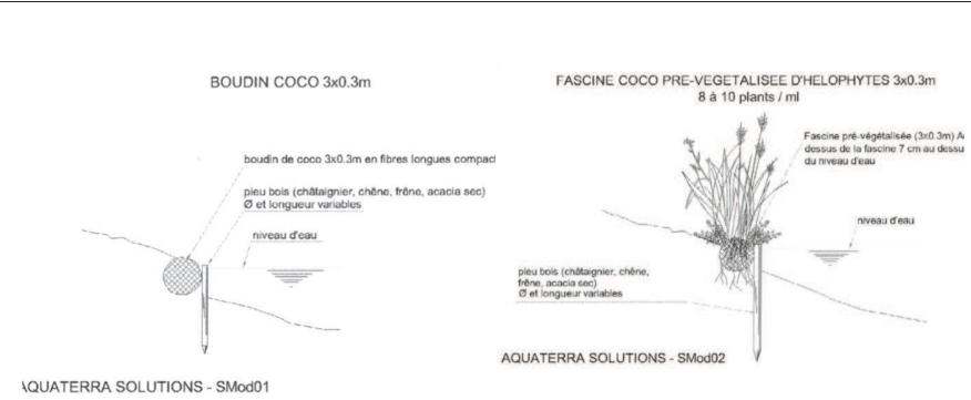
Figure 56 : Schémas de principe d'aménagement de boudins coco (Aquaterra, 2010)
