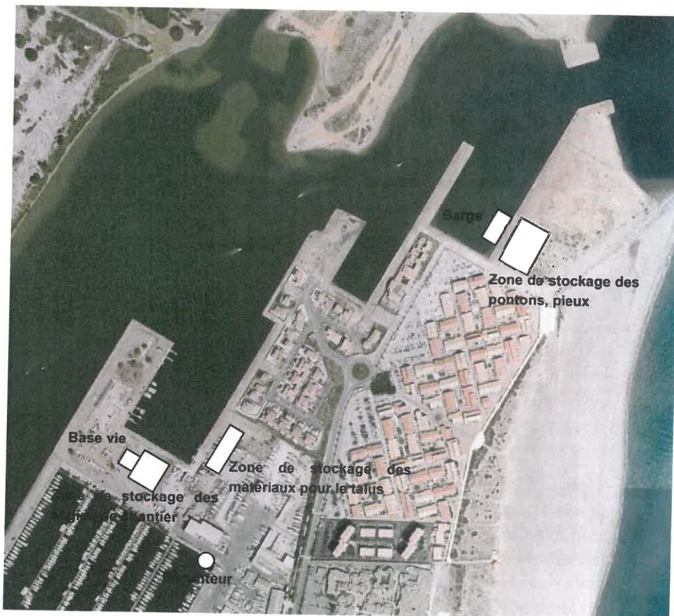
Figure 58 - sites d'installation de la base vie et des zones de stockage des engins et matériaux
