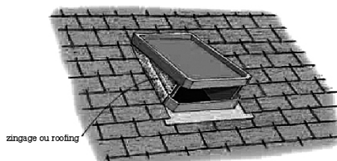
6. Aménagement d'une tabatière en chiroptière
