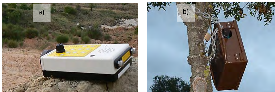
Figure 5 - Dispositifs d'enregistrement automatisé : a) ANABAT SD1 ; b) Wildlife Acoustics SM2 Bat Detector.
