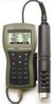
Photo 8 : sonde multi paramètres Hanna Instruments
