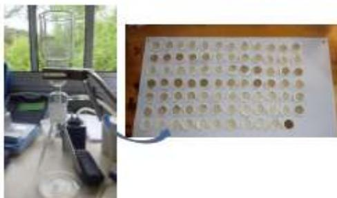
Photo 3 : rampe de filtration à gauche et lot de filtres à MES à droite
