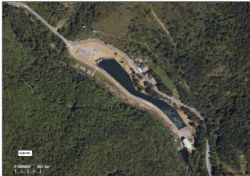
**Figure 2** : Photographie aérienne de l'usine d'Escouloubre avec la prise d'eau sur Aude en rive gauche et le bassin de compensation
