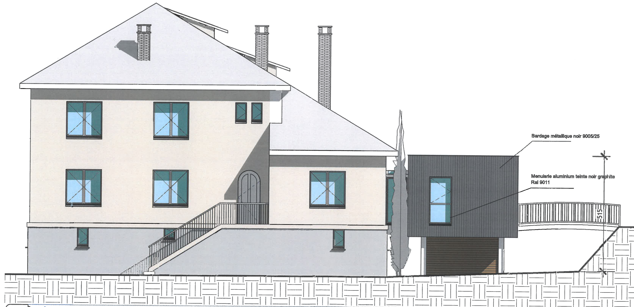
1 Elévation Nord-Ouest Ech : 1 : 100
