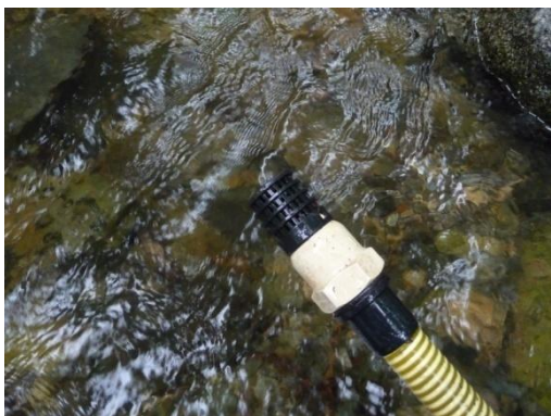
Figure 15 : Tuyau protégé par une crépine conventionnelle.
