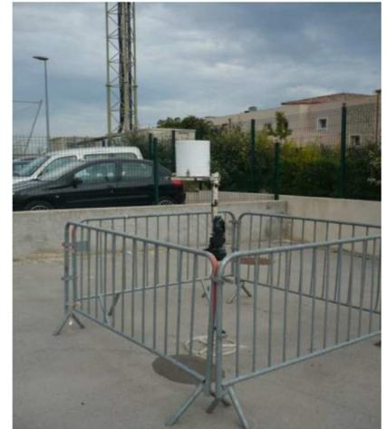
Figure 3 : Pluviomètre à augets 0,2 mm
