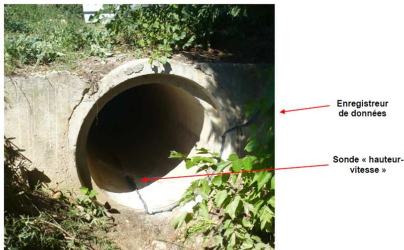
Figure 4 : Mesure de débit de type "hauteur-vitesse" (point M4)
