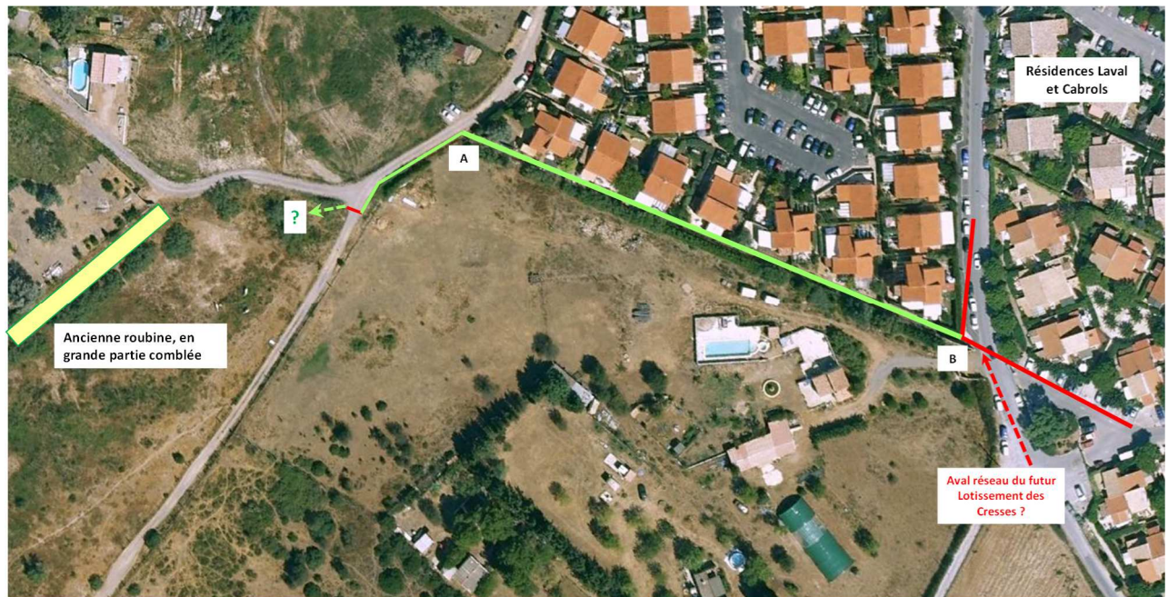
Figure 21 : Bassin versant des Cresses_ Fonctionnement hydraulique actuel
