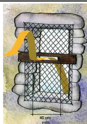
1. Chiroptière dans une ouverture grillagée
