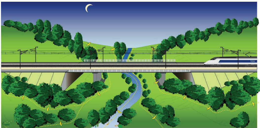
Exemple d'amélioration de la transparence vis-à-vis des chiroptères par aménagement de la structure de la végétation aux abords d'un viaduc – (d'après source Ecosphère)
