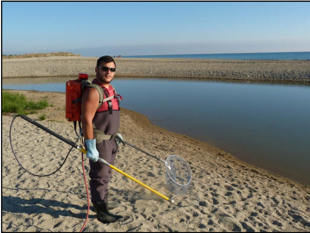
Dispositif de pêche électrique HallTech 2000 avec Anode (perche jaune), Cathode (câble rouge) et Générateur (Boîtier dorsal orange) - ©Agence Gaiadomo, 2011- (Photo sur site : Riberette)
