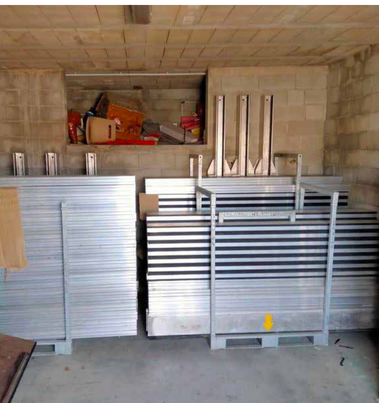
Batardeaux en réserve (Hérault) - photo DREAL Occitanie
