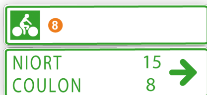
Panneau réglementaire de présignalisation (DV40) (avant l'intersection). Possibilité de faire apparaître les numéros de boucles ou identifiant d'itinéraire emprunté sur la latte supérieure
