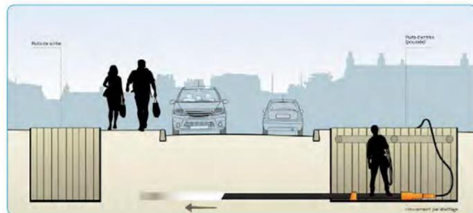
Figure 9 : Schéma de fonçage
