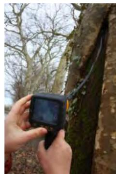
Visite d'une cavité à l'aide d'un endoscope
