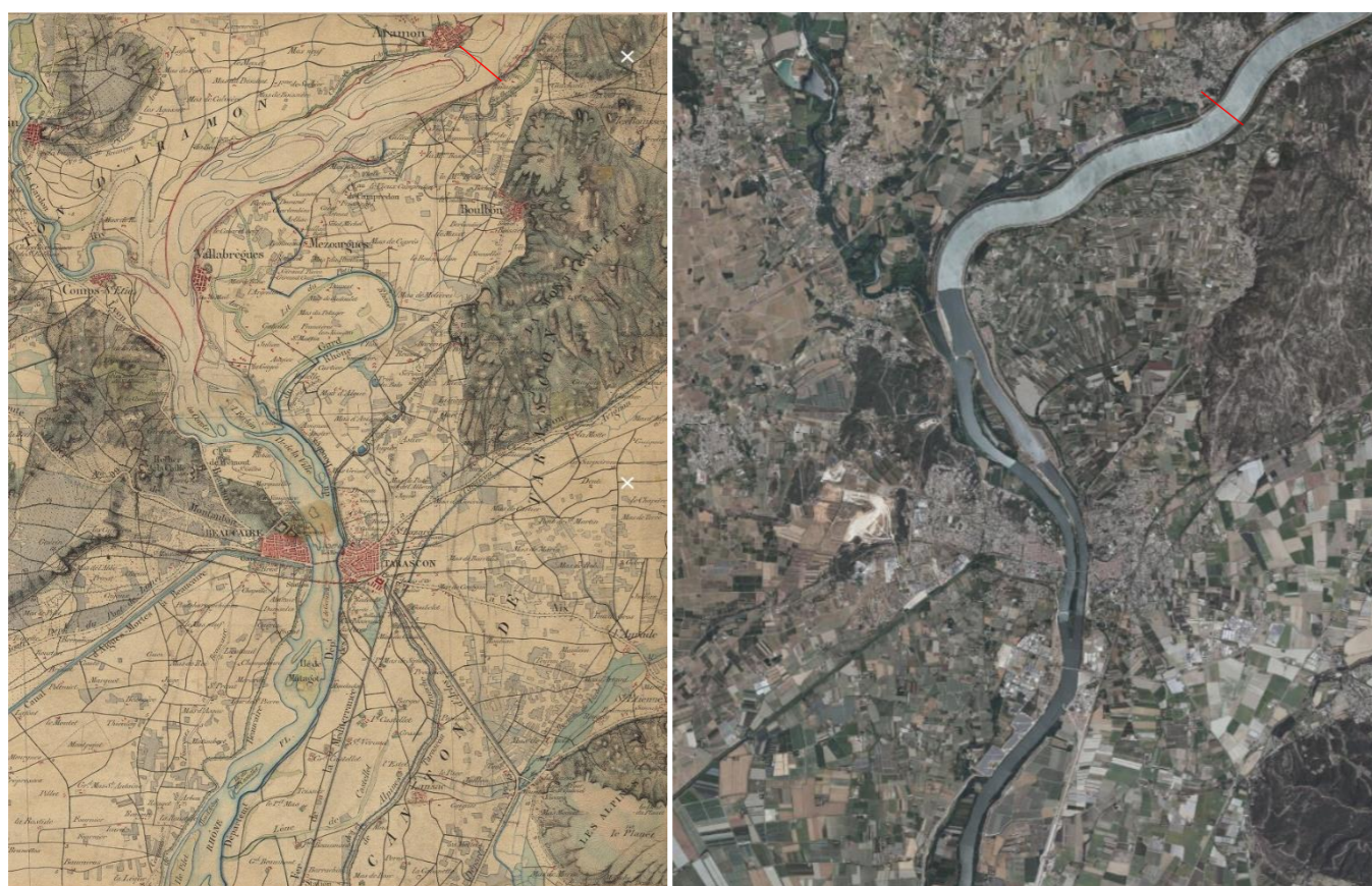
Figure 43. Comparaison du tronçon du Rhône longeant Beaucaire avant et après aménagements de 1870-1890 : En 1866 à gauche et en 2020 à droite (Source : carte de l'Etat major disponible sur remonterletemps.ign.fr et Géoportail) Les traits rouges représente une distance égale en un même endroit aux deux époques différentes.
