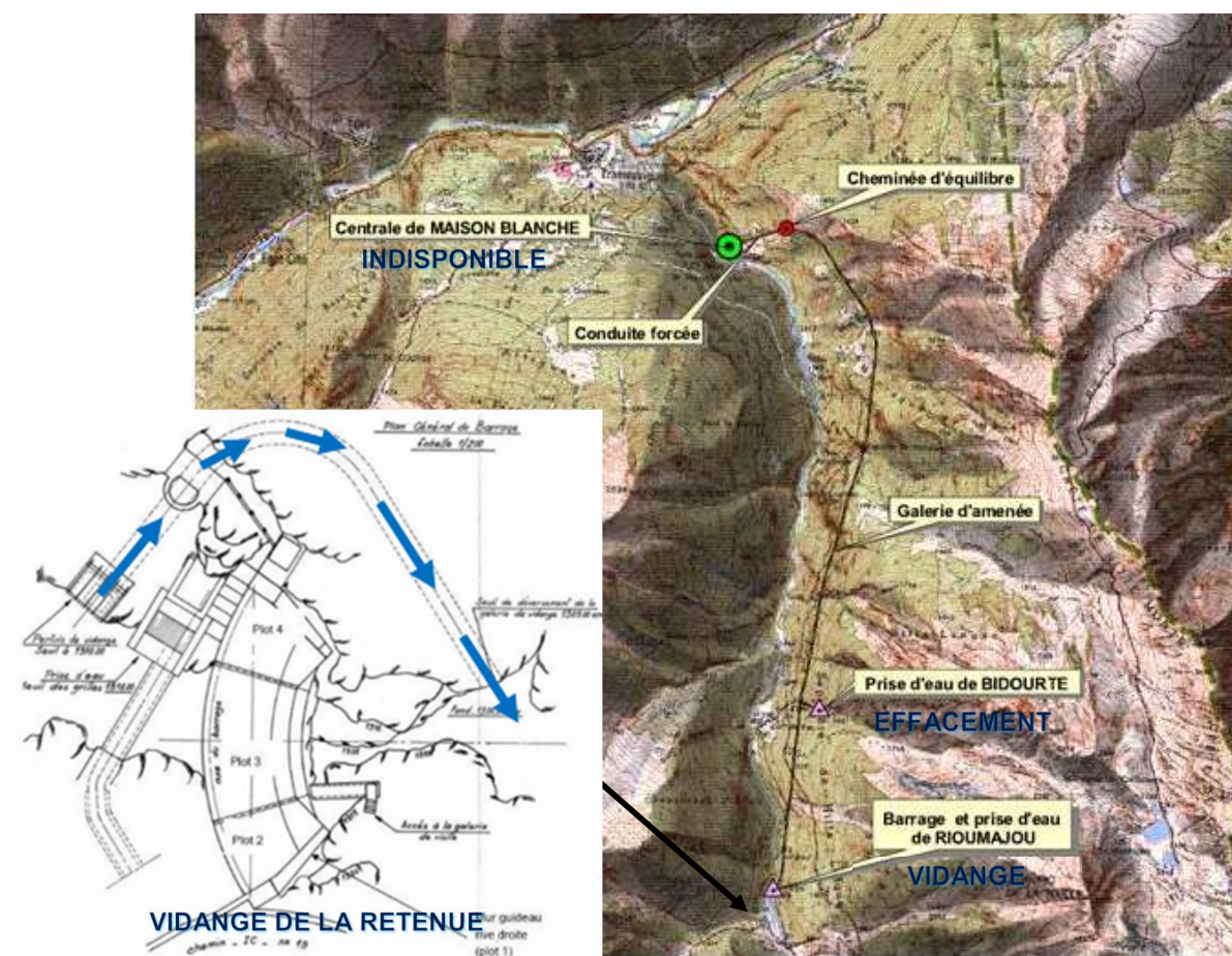
Figure 50 : gestion des ouvrages et mise en indisponibilité
