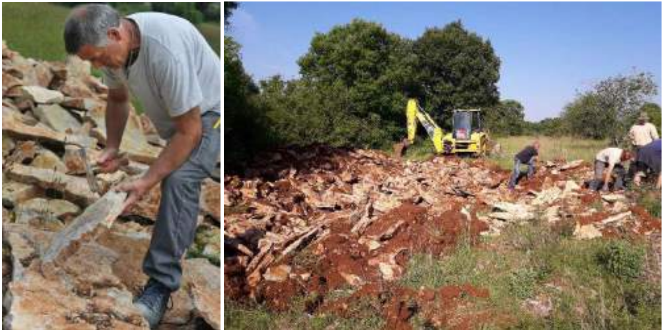
Artisan lauzier faisant « sonner » la lauze pour s'assurer de sa qualité et Micro-carrière de lauzes calcaires à Grèzes (46) – extraction des lauzes à maximum 80 cm de profondeur
