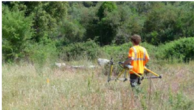
Figure 72: Recherche d'anomalies magnétiques à l'aide d'un détecteur magnétométrique (source : SMGG)
