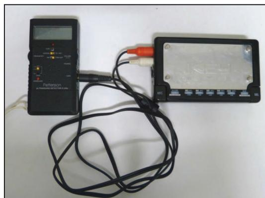
**Matériel de détection ultrasonore utilisé (SM2 Bat à gauche et détecteur Pettersson avec enregistreur à gauche)**
