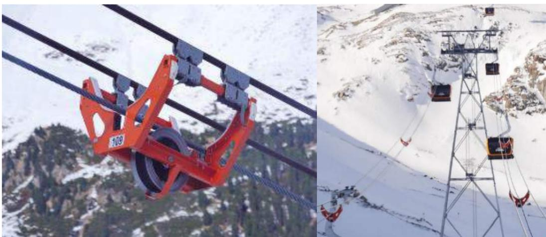
Figure 127 : A gauche = photo d'un cavalier. A droite = exemple d'insertion des cavaliers sur les câbles
