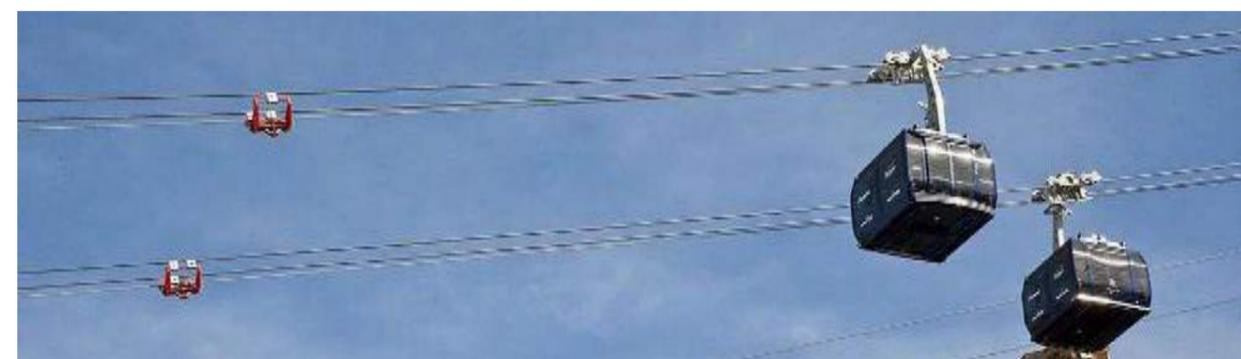
Figure 25 : Photo montrant un cavalier en position de chaque côté de la ligne (source : Groupement POMA, 2018)
