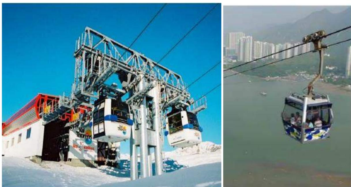
Figure 19 : Funitel à Val Thorens, France (g.) et téléphérique 2S à Hong Kong (source : Etude de faisabilité d'un système de transport à câble)
