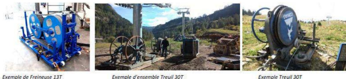
Figure 67 : Exemples d'outillages utilisés pour le déroulage des câbles
