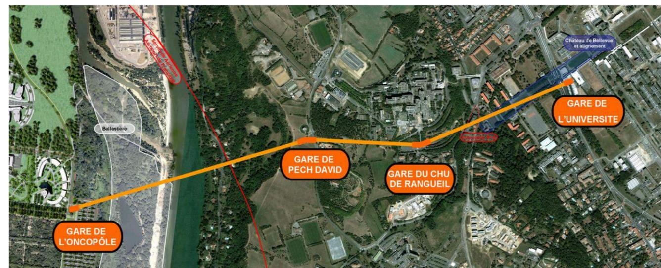
**Figure 11 : Tracé alternatif avec 4 stations dont celle de Pech David (source : Etude de faisabilité d'un système de transport à câble, CUGT, 2010)**
