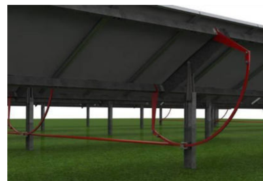
Illustration 1 : aperçu du système de pivot (en rouge)
