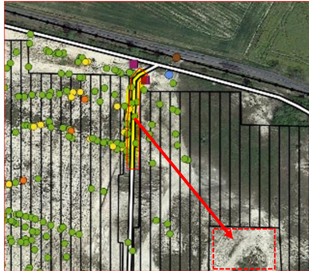
Localisation de la zone à décapier (piste centrale – tronçon 150 m) et de la zone réceptrice
