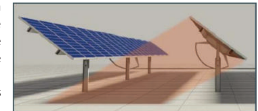
Figure 2 : Schéma de principe d'une ombre portée de trackers (ombre évolutive)
