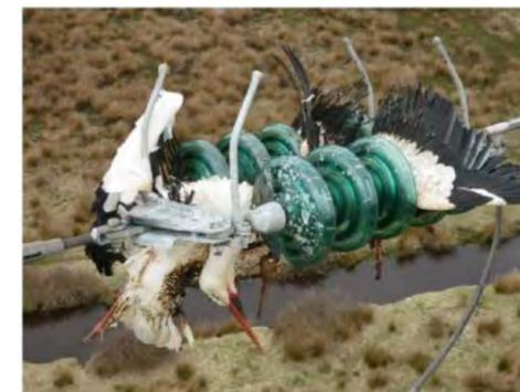
Figure 2 : Cas d'électrocution sur une chaîne d'isolateurs
