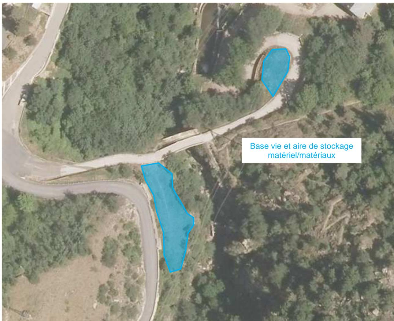
Figure 35 : schéma d'implantation des installations de chantier (phase 1)
