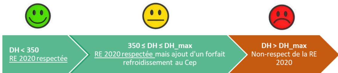
Figure 17 : Schéma explicatif sur la conformité des DH par rapport aux seuils
