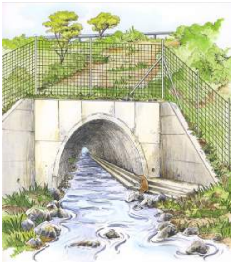
Figure 6. Exemple d'aménagement d'un passage à faune sous une route. Le grillage évite aux animaux de monter sur la route et les canalise vers le passage, dans lequel des marches de différentes hauteurs assurent le franchissement quelle que soit la hauteur de l'eau.
