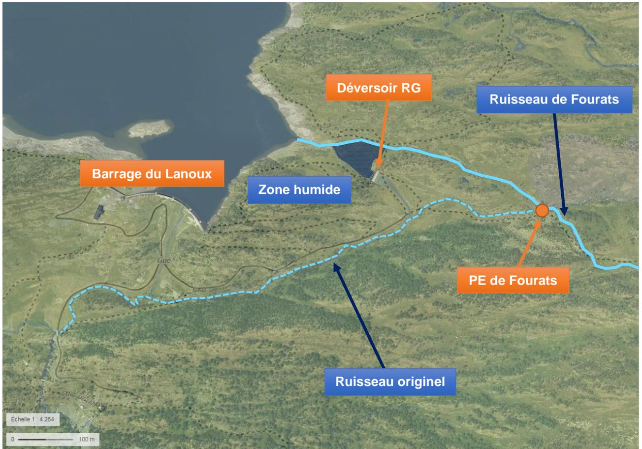
Figure 22 : modification du tracé du ruisseau de Fourats
