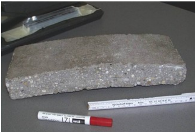
Plan de rupture vertical en pied de voute
