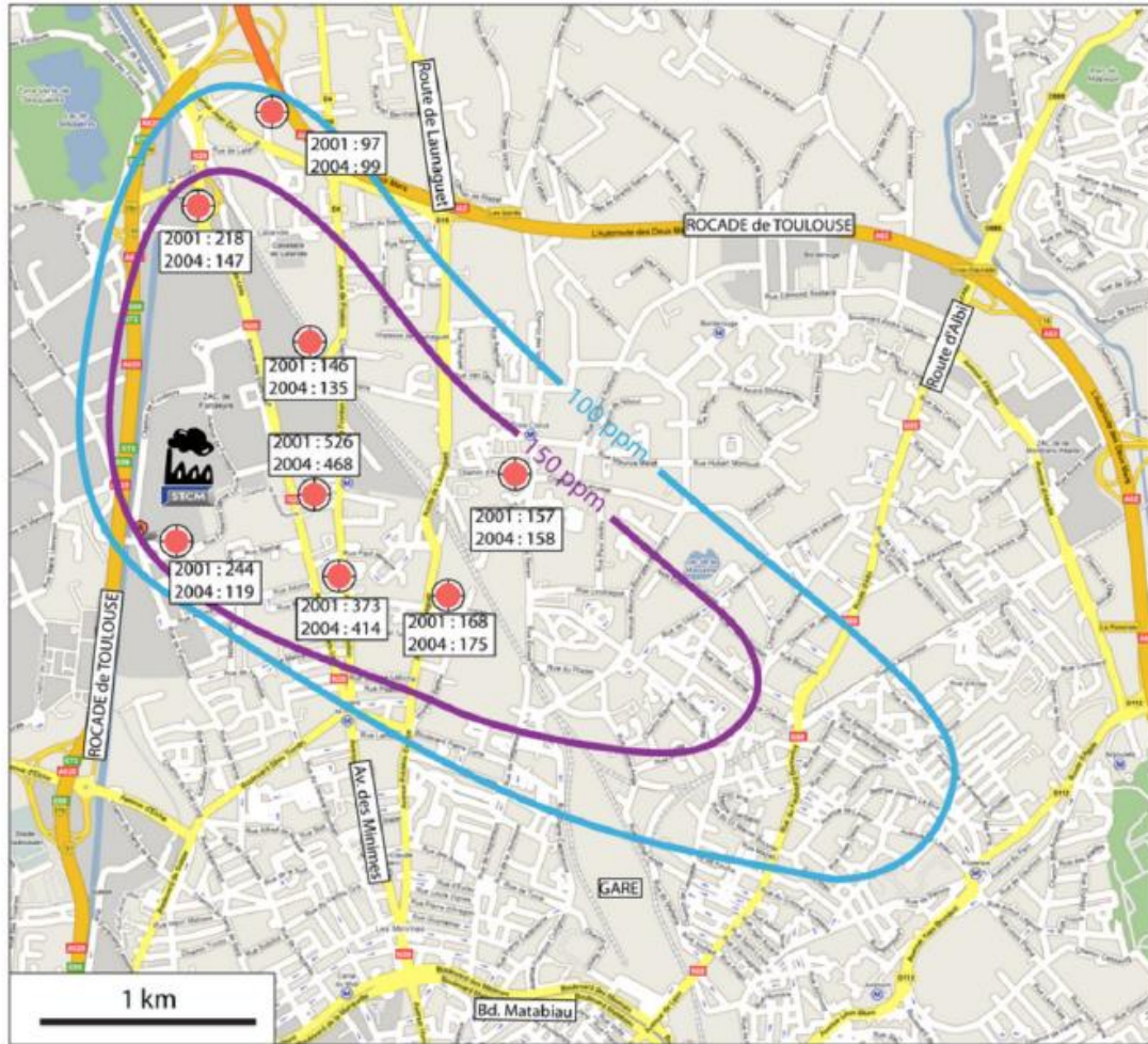
Figure 8 : Courbes d'iso-concentration en plomb 0-25 cm (violet : 150 mg/kg, bleu : 100 mg/kg) autour de l'usine et concentrations ponctuelles mesurées en 2001 et 2004. source : www.googlemaps.com pour le fond de carte
