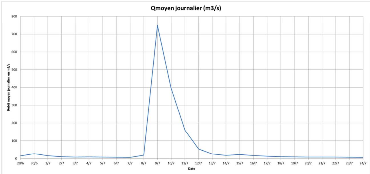
**Figure 4 : hydrogramme de la crue de juillet 1997 sur le Gers à Layrac (débits journaliers) – débit de pointe estimé à environ 1040 m<sup>3</sup>/s**
