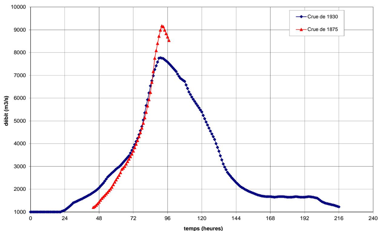
**Figure 2 : Hydrogrammes des crues de 1875 et 1930 à partir des limnigrammes et de la courbe de tarage du Service d'Année des Crues pour la période antérieure à 1972 (source ISL 2008). Nb : les données sont indisponibles sur la décrue de 1875**
