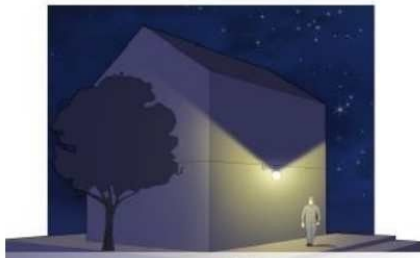
Éclairage moyen : le flux est majoritairement dirigé vers le bas mais une partie importante de celui-ci dépassé le plan horizontal. La pollution lumineuse est importante.
