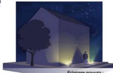
Éclairage mauvais : le flux est dirigé du bas vers le haut avec de fortes déperditions et une forte pollution lumineuse.
