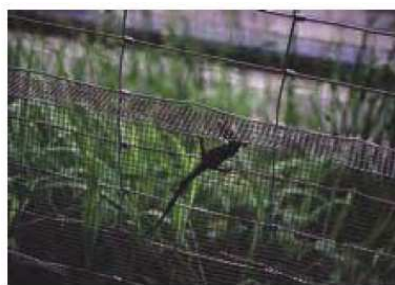
Photo 6 : Triton escaladant un treillis de 6,5x 6,5 mm plaqué sur un treillis noué à spirale ; l'ascension est stoppée par le rabat (partie supérieure recourbée) - Source : H. Bekker
