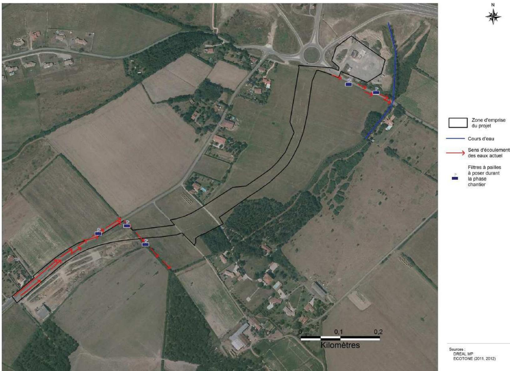
Figure 60 : Localisation des filtres à pailles ou géotextiles à installer
