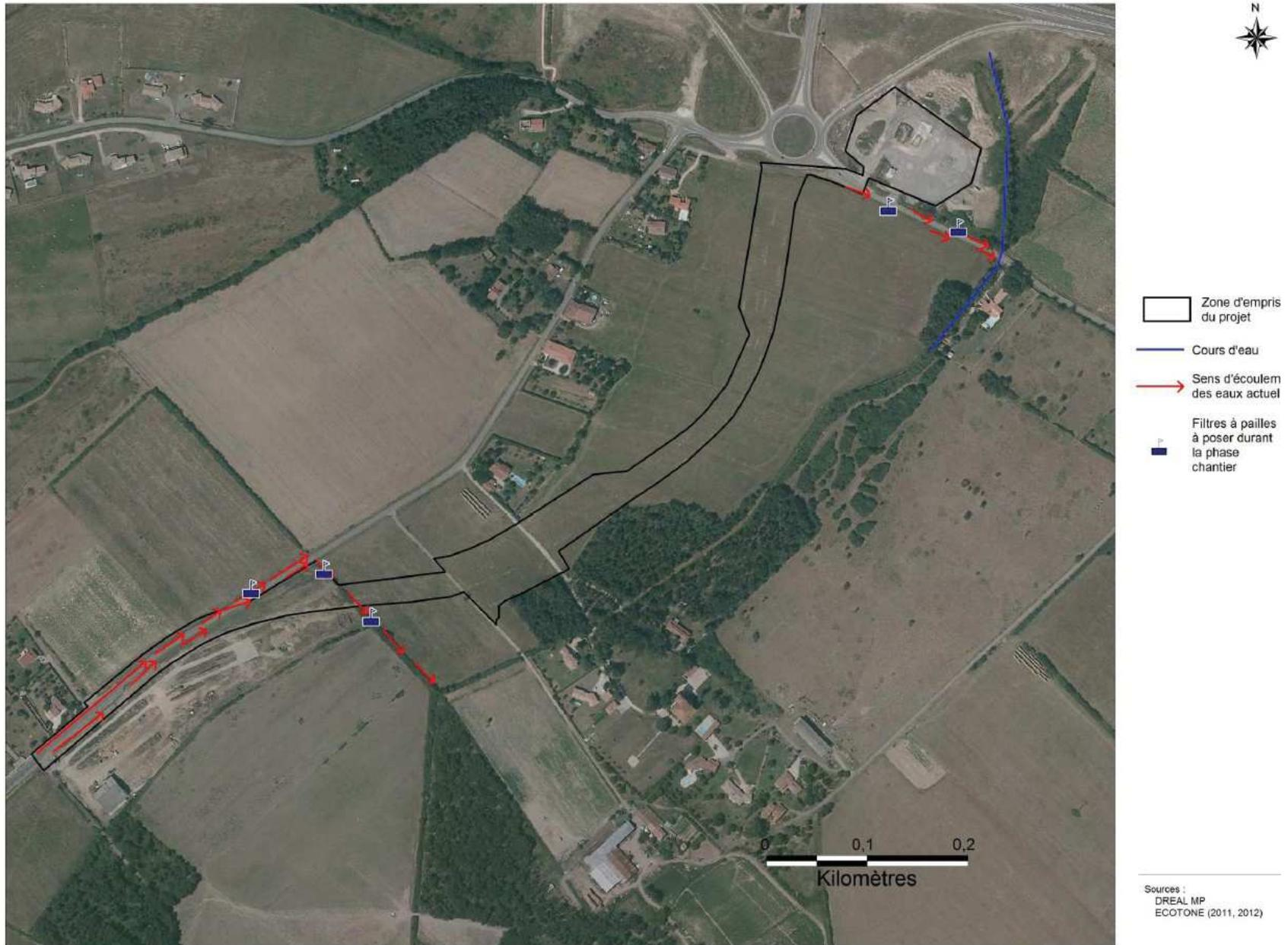
**Figure 22 : Localisation des filtres à pailles ou filtres géotextiles à installer**
