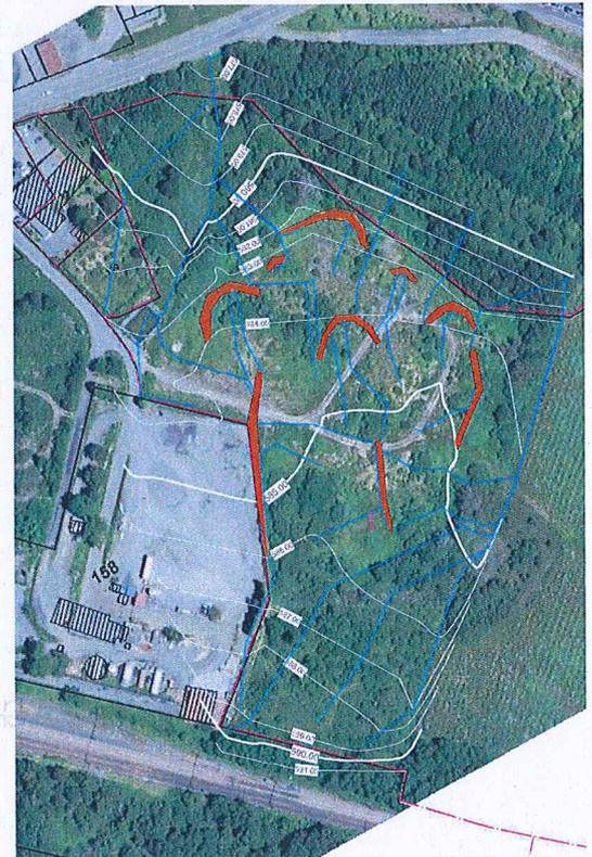
Figure 9 : Mise en place de merlons, aménagements hydrauliques
