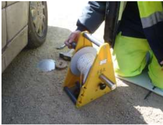
Mesure d'un niveau piézométrique par ruban Barrage de Châtaudren (22) ©DREAL Bretagne Olivier ORHANT – mars 2021
