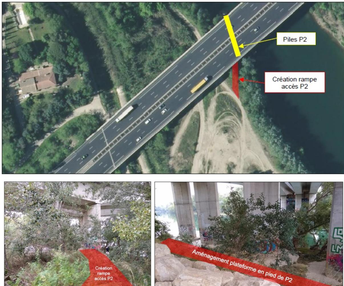
Figure 39 : Localisation schématique et illustration des aménagements pour accès à la pile P2 (Arcadis, 2021)
