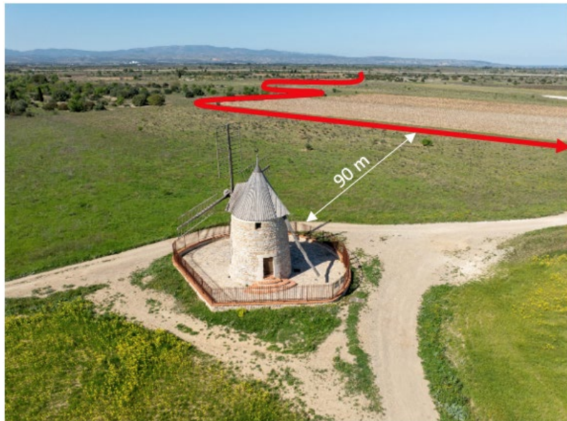
Figure 59 Traversée du ruisseau de Clair en forage droit (Source : ETC21 / Piece 3)
