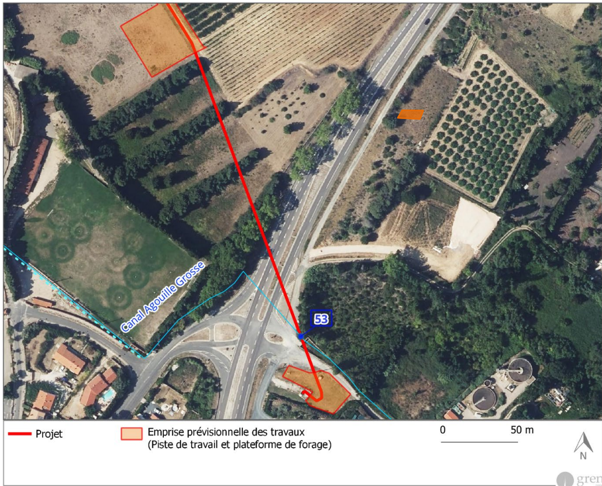
Figure 95 Traversée de l'Agouille Grosse (FHD)
