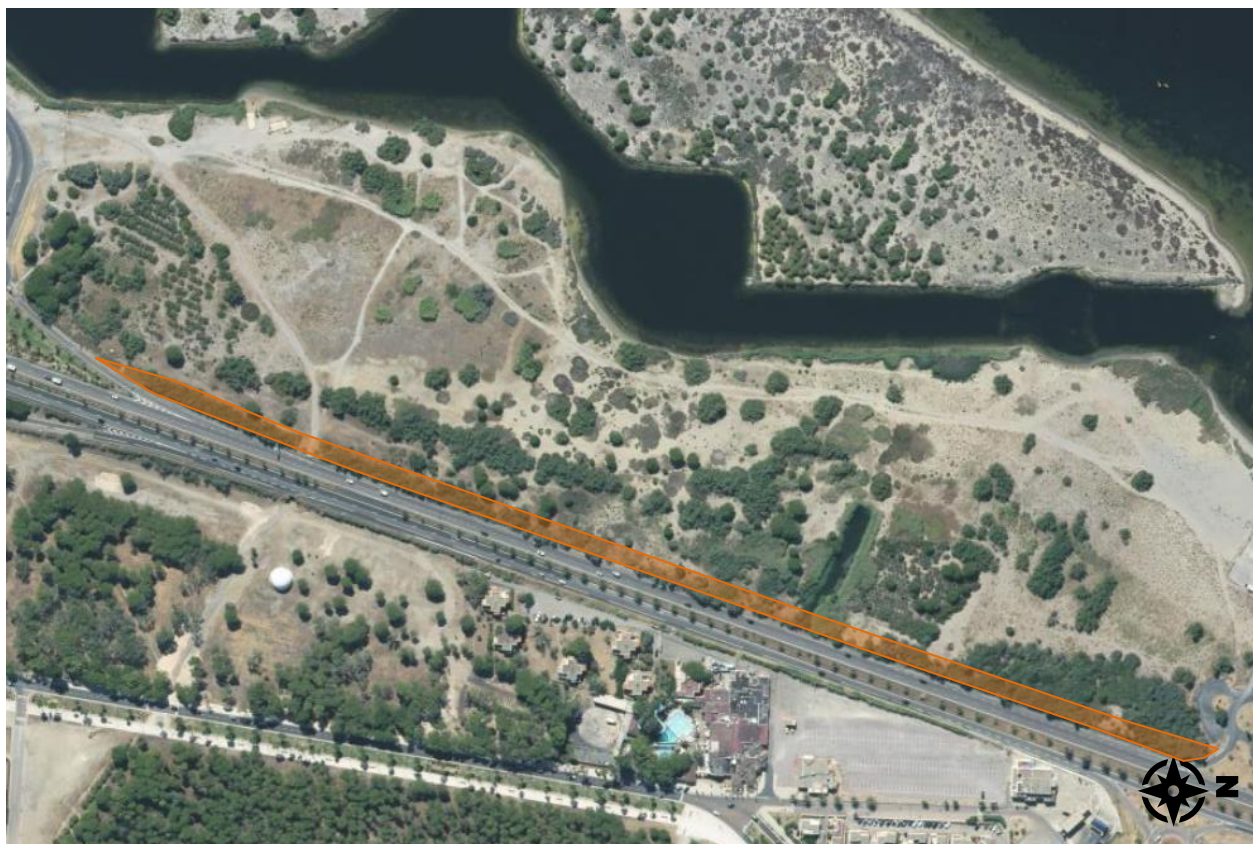
Figure 9 : Matérialisation de la bande de 10 mètres à débroussailler
