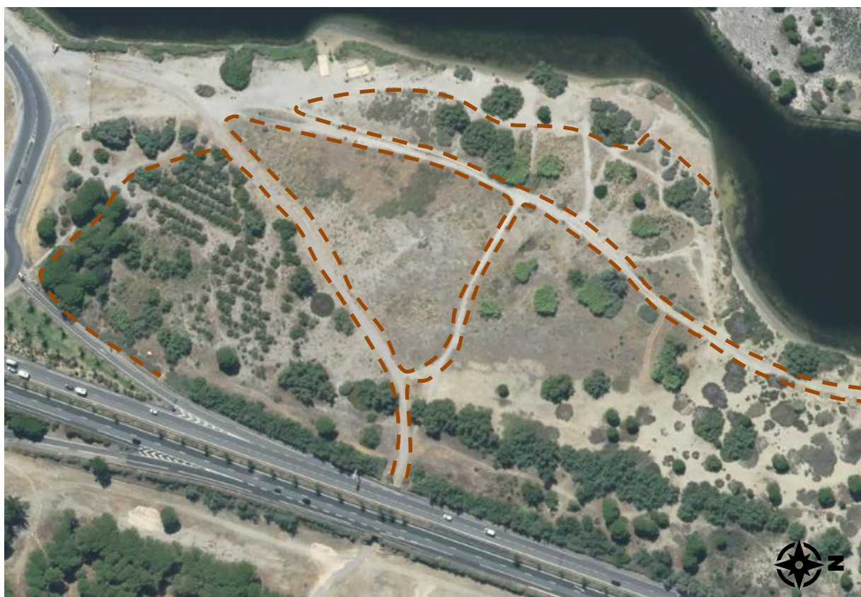
Figure 6 : Exemple d'installation possible de ganivelles en bord de chemin (partie Nord en haut et partie Sud en bas)
