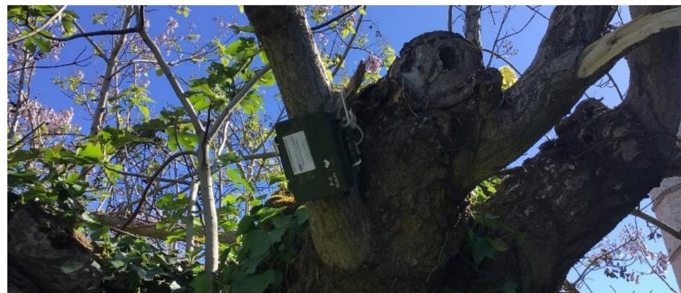
Figure 11 : Enregistreurs ultrasonores automatiques type SM Mini Bat+ (photographies prises le 19/04/2024)
